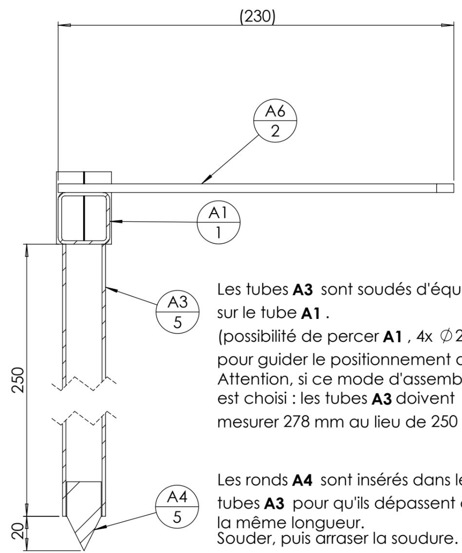
Les tubes **A3** sont soudés d'équerre sur le tube **A1**.
