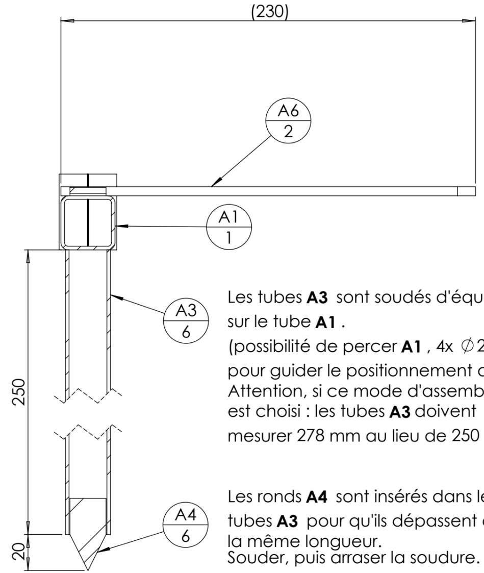
Les tubes **A3** sont soudés d'équerre sur le tube **A1**.
