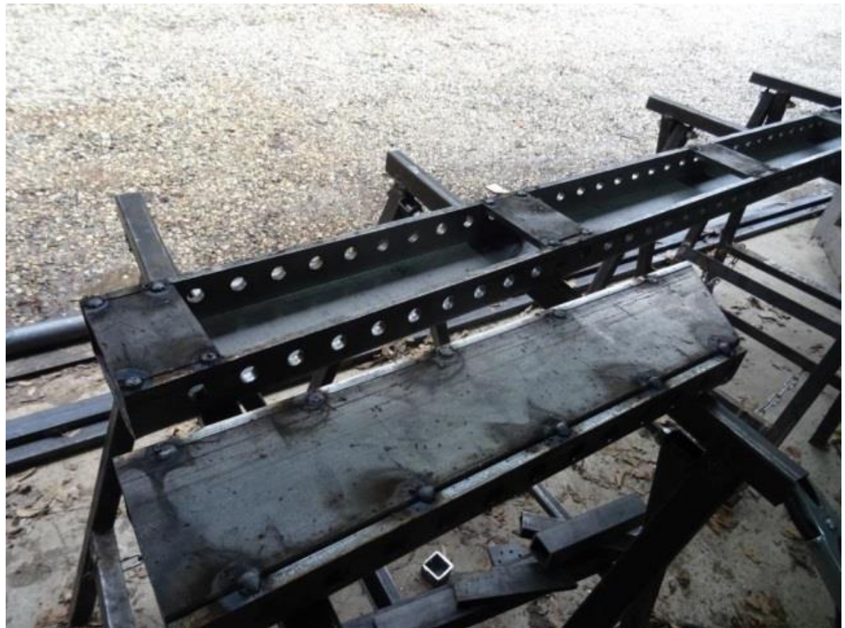
Renforts A2 et A3 pointés sur les tôles pliées :
