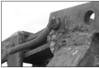
Lumière d'articulation du triangle d'attelage.
