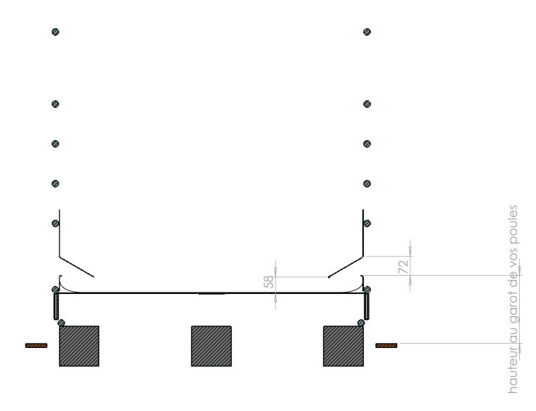
Souder ces 4 points pour renforcer la ca couronne d'écoulement
