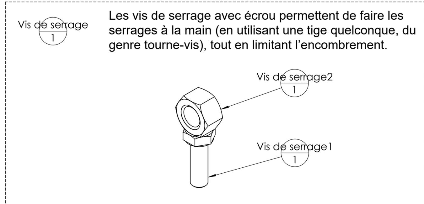
Les vis de serrage avec écrou permettent de faire les serrages à la main (en utilisant une tige quelconque, du genre tourne-vis), tout en limitant l'encombement.
