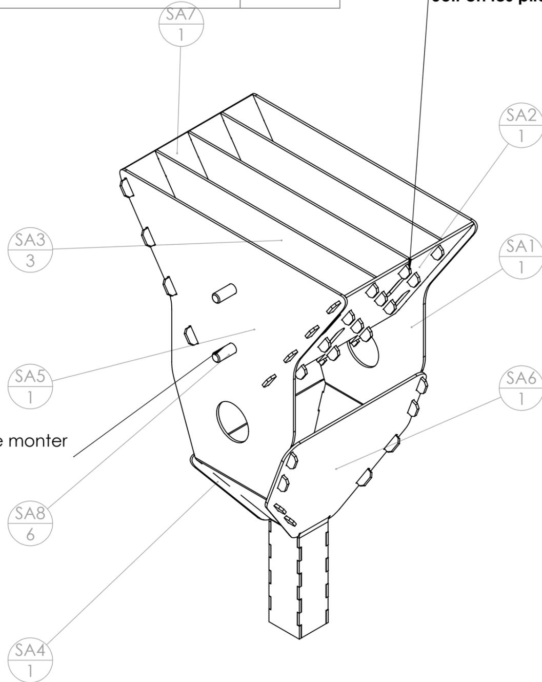
Souder les vis avant de monter les tôles.
