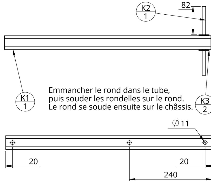
Emmancher le rond dans le tube, puis souder les rondelles sur le rond. Le rond se soude ensuite sur le châssis.
