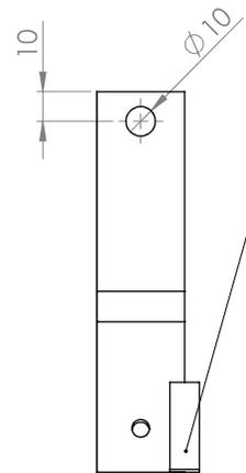
La pièce CS3 sert de butée au clinquant pour éviter qu'il ne pivote. Souder CS3 une fois le clinquant monté, en veillant à la bonne orientation de ce dernier, et au bon contact entre CS3 et le clinquant.
