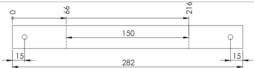
Lignes de plis de CS2 : coincer la partie longue dans un étau, jusqu'à la ligne de pli. Puis plier au marteau ou avec un tube ajusté comme bras de levier. Attention à ne pas faire vriller le plat.
