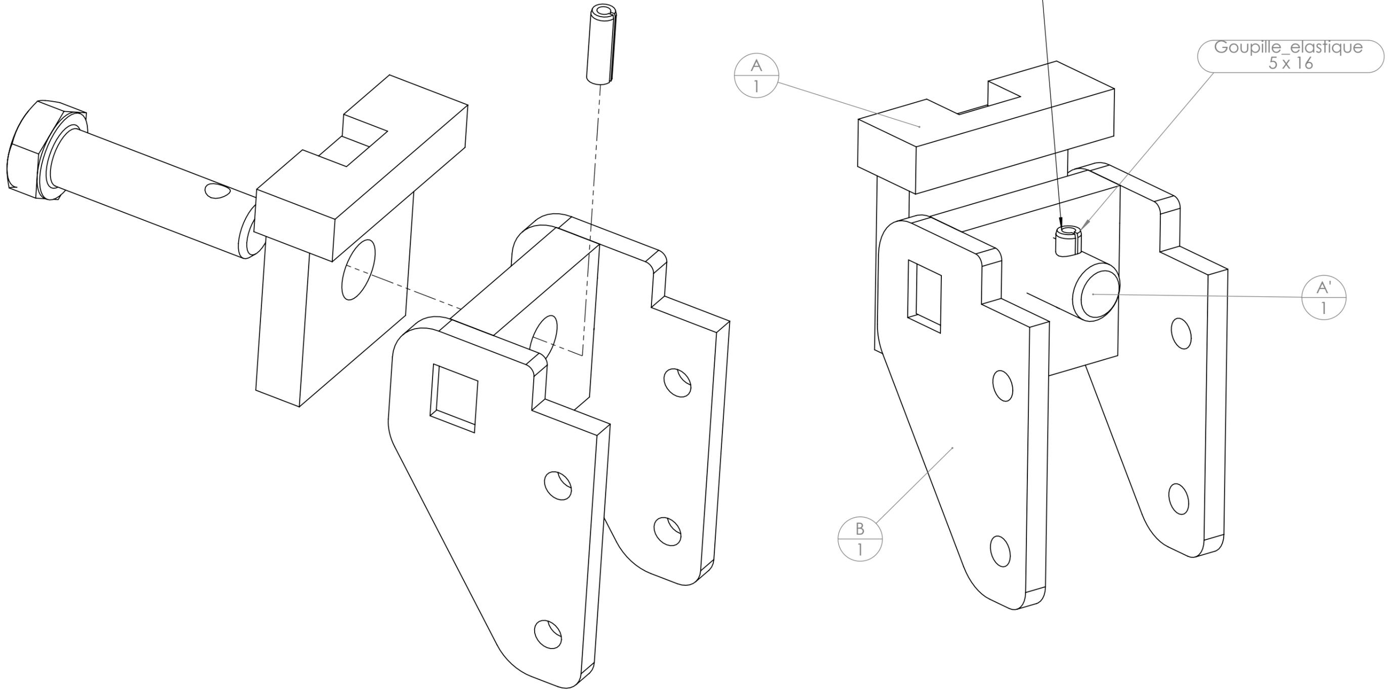
**La goupille élastique permet un desserrage/démontage sans risquer d'enlever le taquet de la bride**
