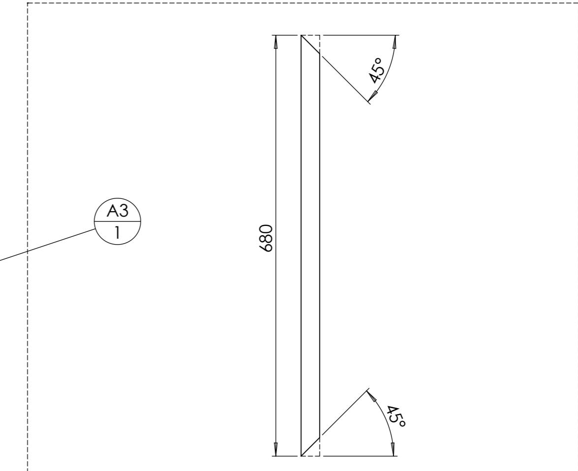
Fer plat à cintrer de façon à ce qu'une chaussure puisse s'insérer facilement pour aider au retrait de l'outil.
