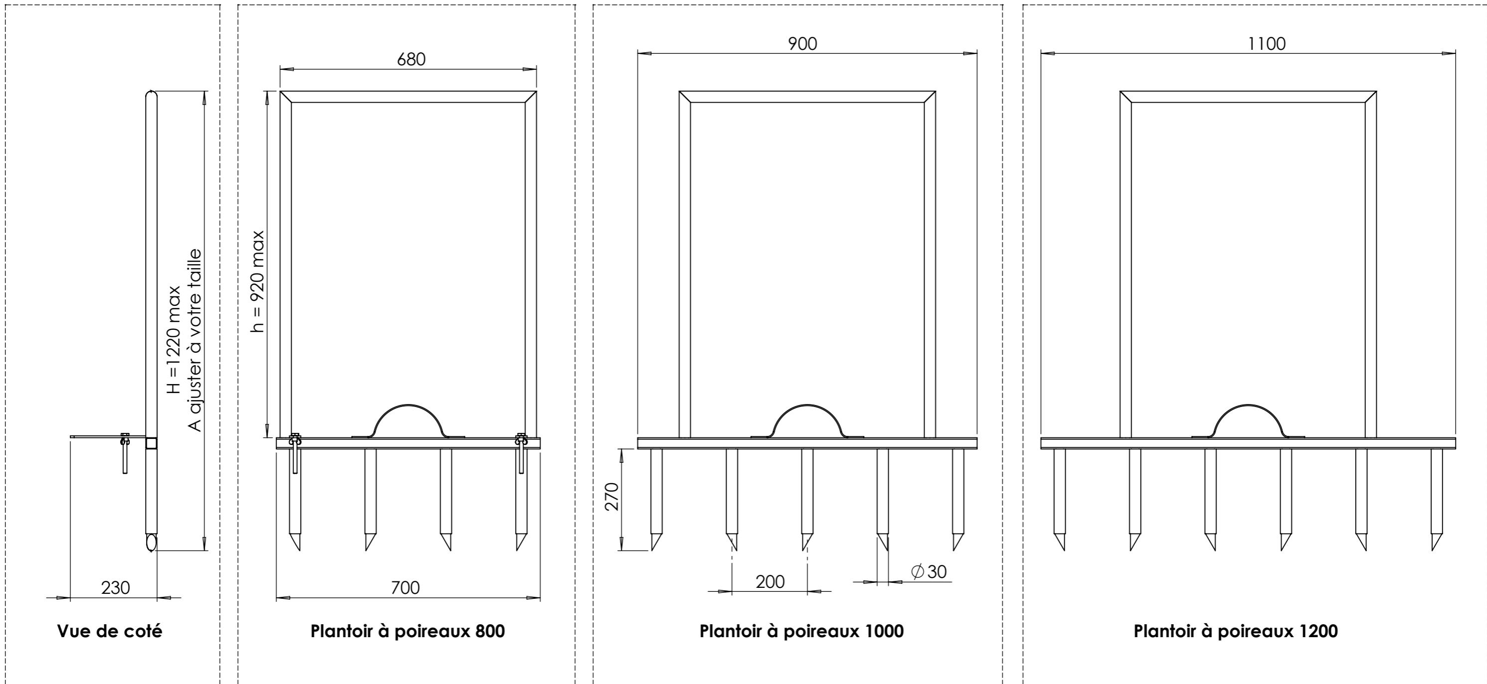
Dans l'idéal, le manche du planter à poireaux doit arriver à hauteur des coudes, pour que les bras soient à 90° en position relevée et tendus pour extraire les dents du sol. Pour cela il faudra adapter la fabrication du manche (voir pages A - Détails).
