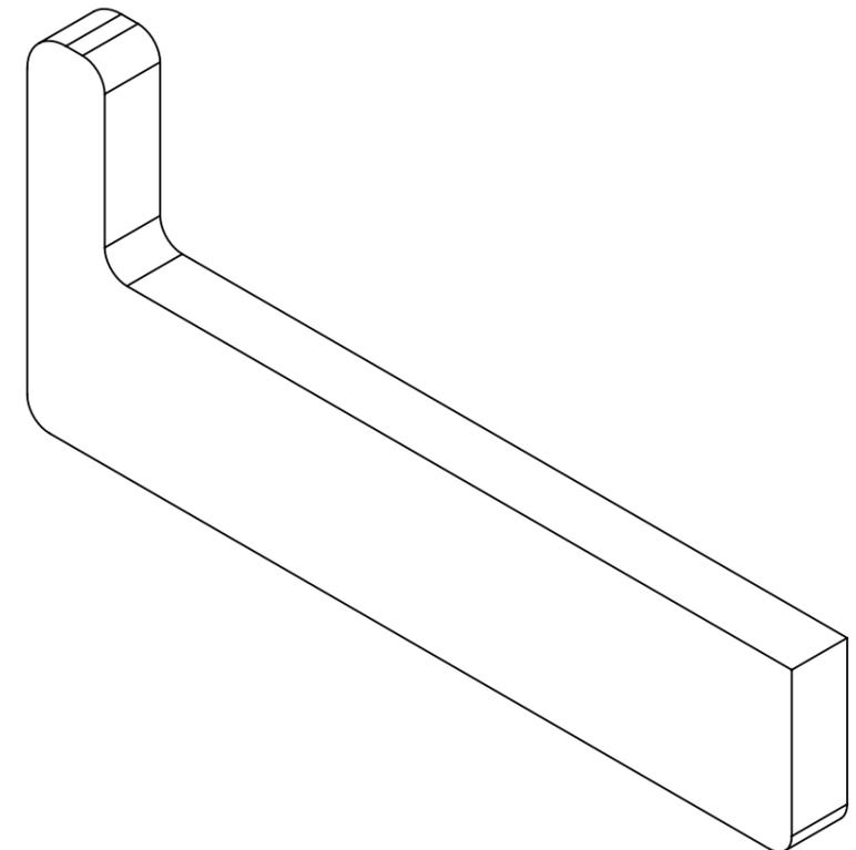
Platine pouvant être réalisé à partir d'un fer plat.
