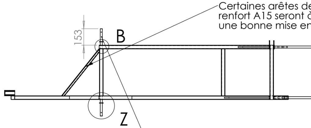
souder A14 sur A4 et A7 avant la soudure de la traverse A8 en suivant les 3 étapes ci-contre =>
