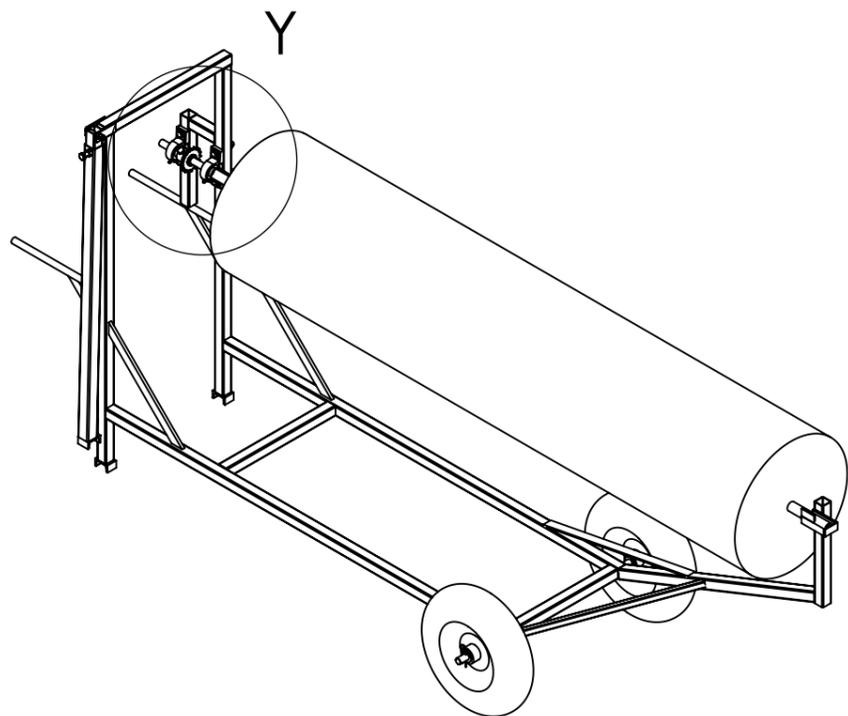
il faut que les percages de cette barre soient alignés avec les trous de la barre de gauche afin que l'alignement de l'axe soit bon
