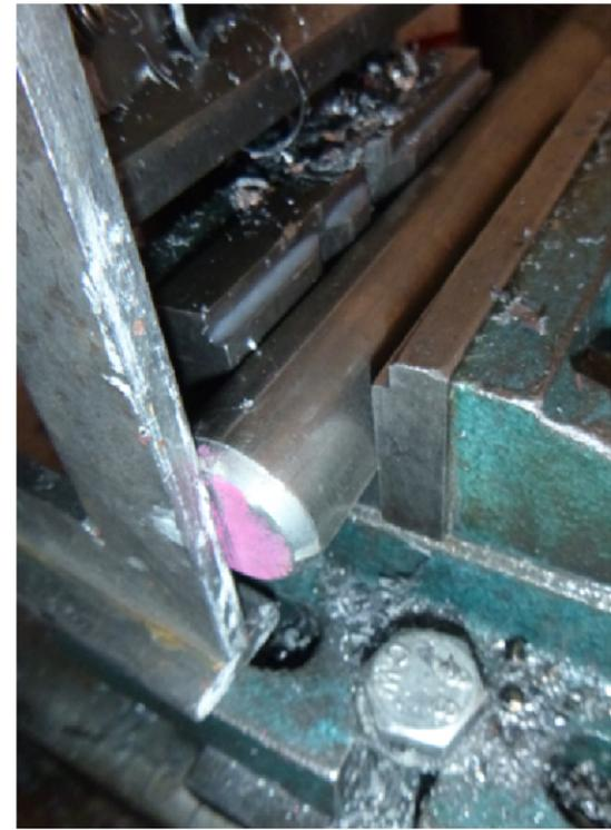
Pour bien percer l'axe, utiliser un trusquin pour marquer le milieu de l'axe sur sa longueur et son extrémité. Une fois dans l'étau, vérifier la coaxialité à l'aide d'une équerre.
