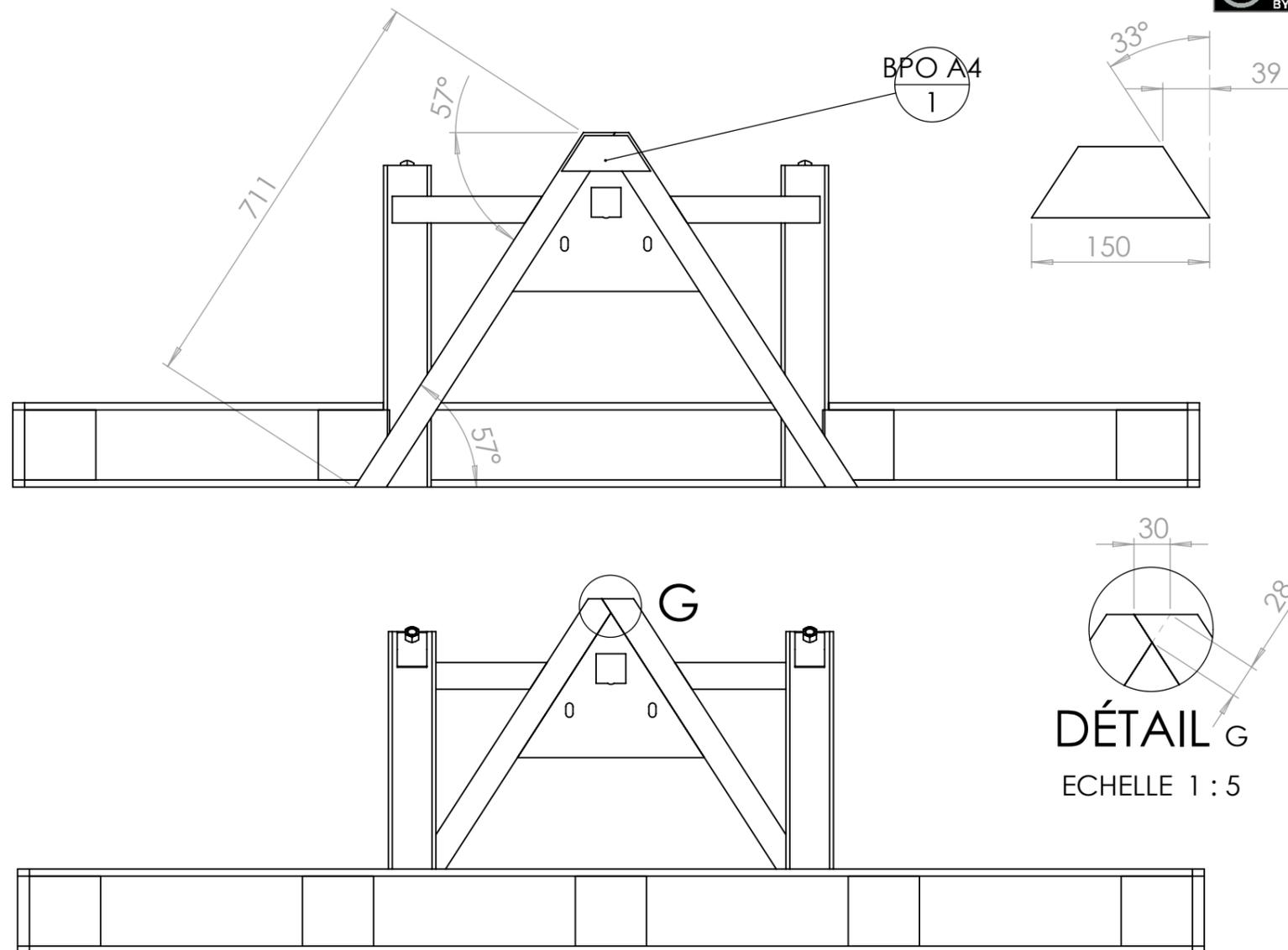
Le jeu au niveau des perçages pour les broches étant faible, il peut être nécessaire de passer un étiré de 16 au marteau dans chaque trou de la BPO pour casser la bavure du laser
