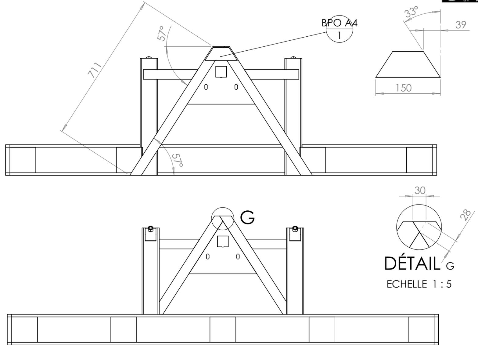
Le jeu au niveau des perçages pour les broches étant faible, il peut être nécessaire de passer un étiré de 16 au marteau dans chaque trou de la BPO pour casser la bavure du laser
