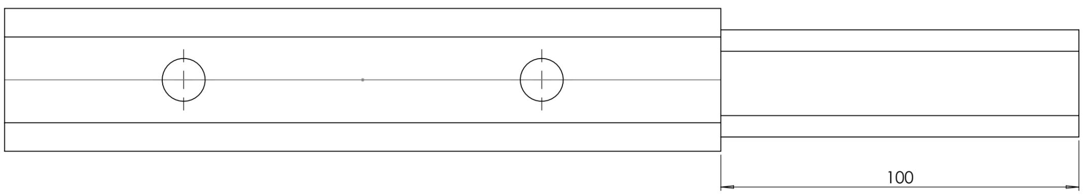
Le tube est plaqué dans le coin et les soudures bouchons se font sur une face plaquée.
