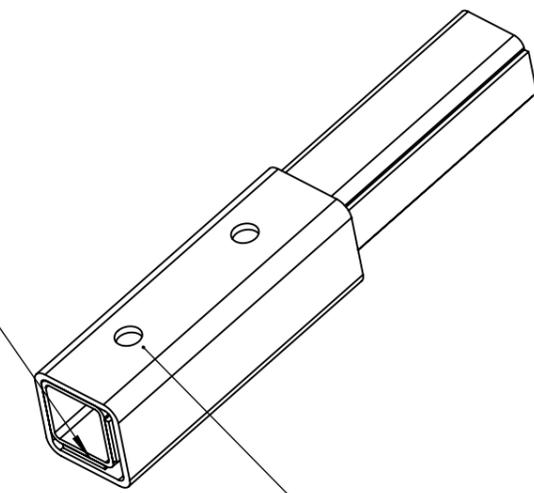
Soudures bouchons sur les faces opposées aux fers plats pour souder le tube.
