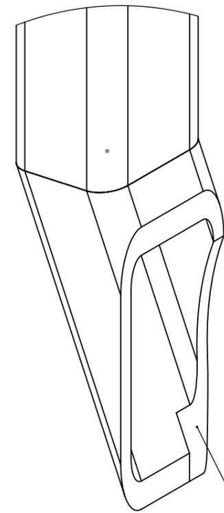
Réaliser une encoche à la meuleuse pour que la descente soit plus ouverte vers l'arrière. Attention à l'orientation de l'encoche par rapport à l'orientation du disque
