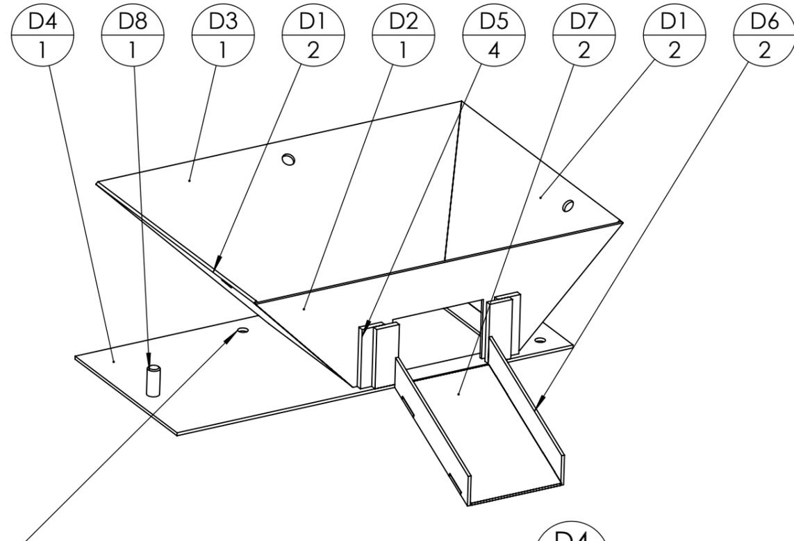
Attention à bien respecter le sens de  $\frac{D4}{1}$  ce perçage doit être placé ici.
