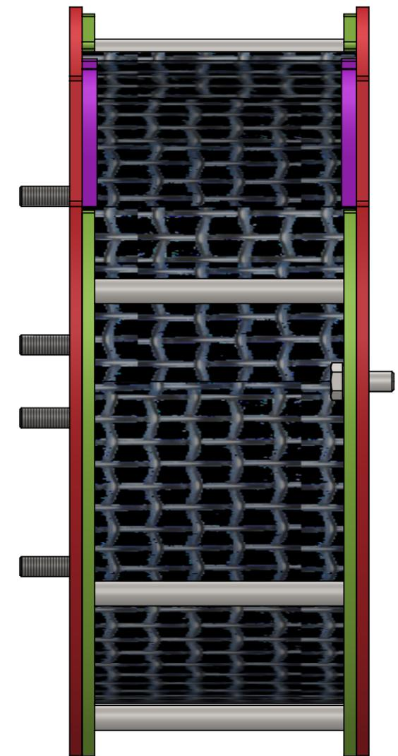
La grille  $\frac{GD1}{1}$  est à coincer entre les tiges  $\frac{GC}{6}$  et les rainures dans  $\frac{GB}{2}$  ce qui permet de la plier et la maintenir en place.
