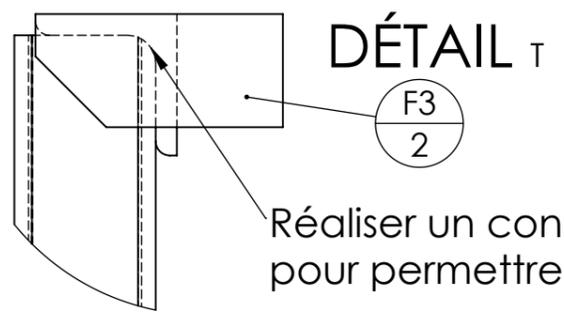
Réaliser un congé de 4mm sur F2 pour permettre un bon contact avec F1
