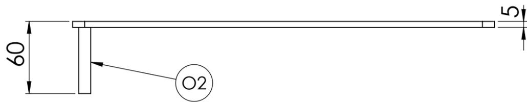
La poignée en bois est rentrée en force sur le fer rond de 10mm. Il faut la pré-percer à Ø9,5mm.
