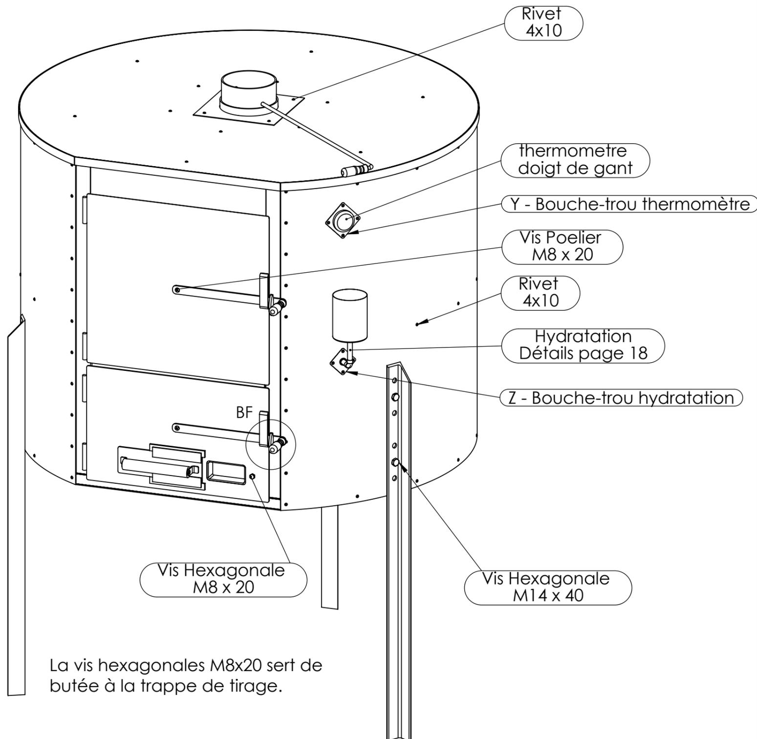
La vis hexagonales M8x20 sert de butée à la trappe de tirage.
