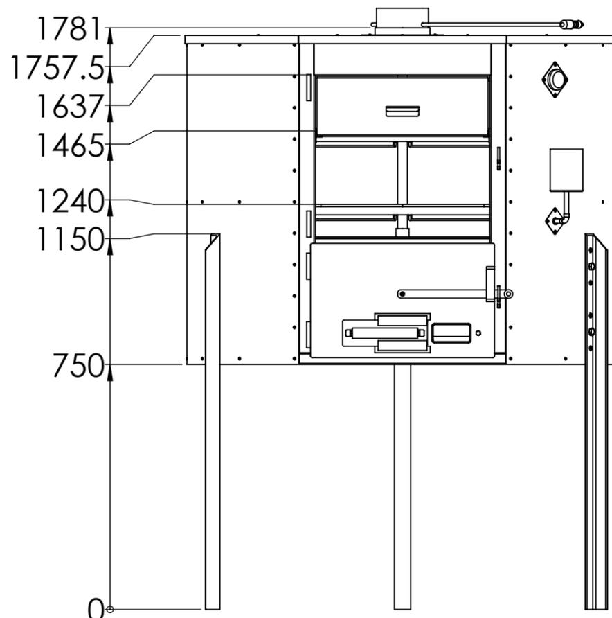
La hauteur des pieds (la longueur de M1) est à ajuster au cas par cas (hauteur de remorque ou utilisation au sol, taille du boulanger ou de la boulangère). On peut partir sur une hauteur finale du haut du four 5cm en dessous de la taille du boulanger ou de la boulangère. Pour une utilisation au sol, se référer au tableau :
