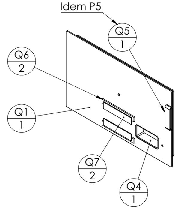
Souder l'écrou M8 brut face intérieure de P1
