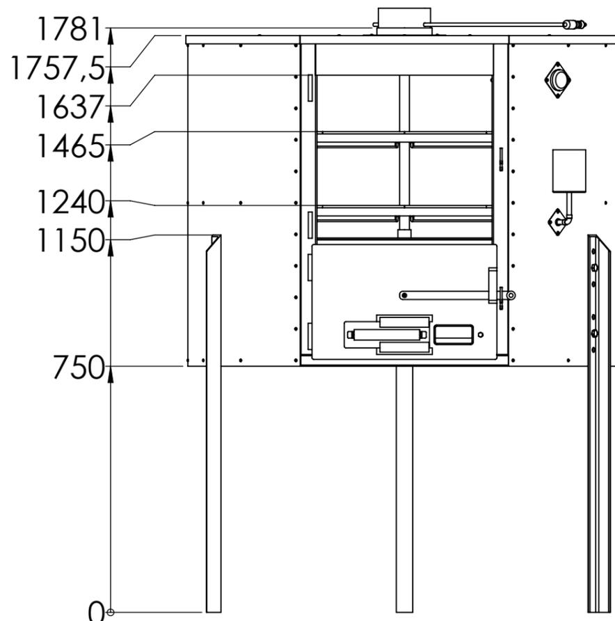
La pièce I reçoit les flammes. C'est une pièce martyre. Elle se glisse dans le rail formé par les deux U A23. La pièce I peut être auto-construite avec 4 morceaux de fer plat de 100x10 soudés bords à bords.
