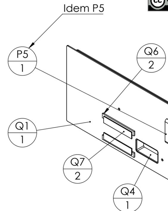
Souder l'écrou M8 brut face intérieure de P1
