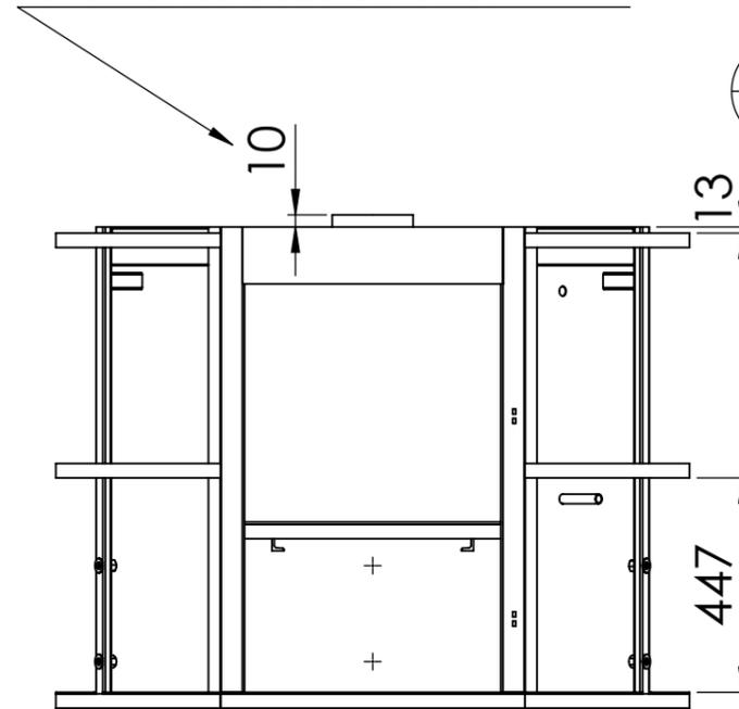
Le tube A54 repose sur les deux morceaux d'UPN A38
