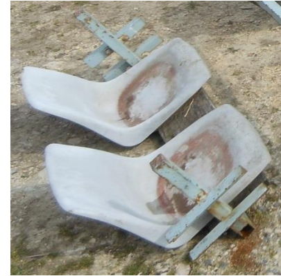
Franck a utilisé de vieux siège en plastique et a soudé l'armature sur a barre latérale.
