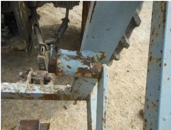
La liaison pivot avec le bras de rouleau (A12)
