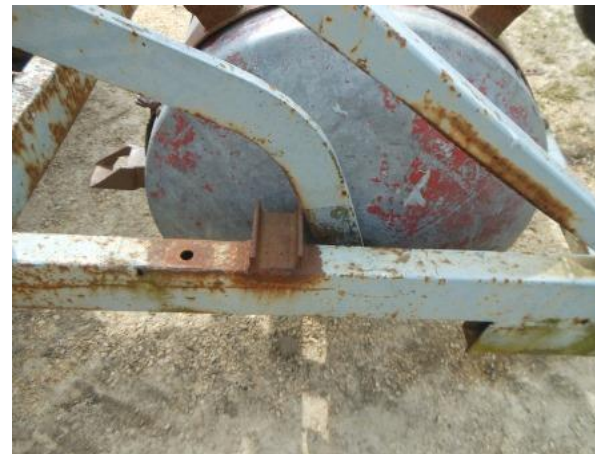
La buté d'arrêt pour le bras de rouleau (A16)
