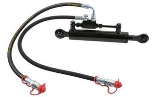
Le troisième point hydraulique n'est pas obligatoire pour l'utilisation du système d'attelage par triangle, dans le sens où l'on peut très bien procéder à l'attelage avec un 3° point manuel. En revanche, il permet d'aller au bout de la démarche ergonomique et sécuritaire du passage au triangle d'attelage, en évitant à l'utilisateur de descendre du tracteur pour régler la longueur du 3° point : ce réglage se fait désormais depuis le poste de conduite, grâce aux leviers de commande hydraulique.
