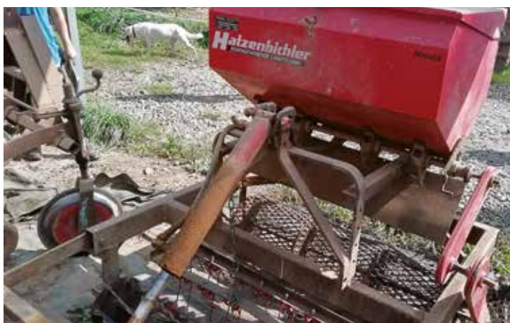
Montage d'une trémie sur un bâti autoconstruit
