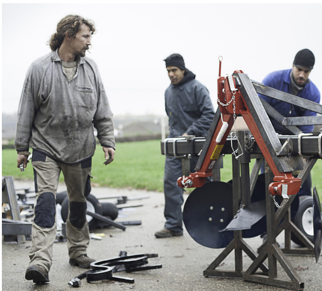
▲ Montage final d'une butteuse à planche
