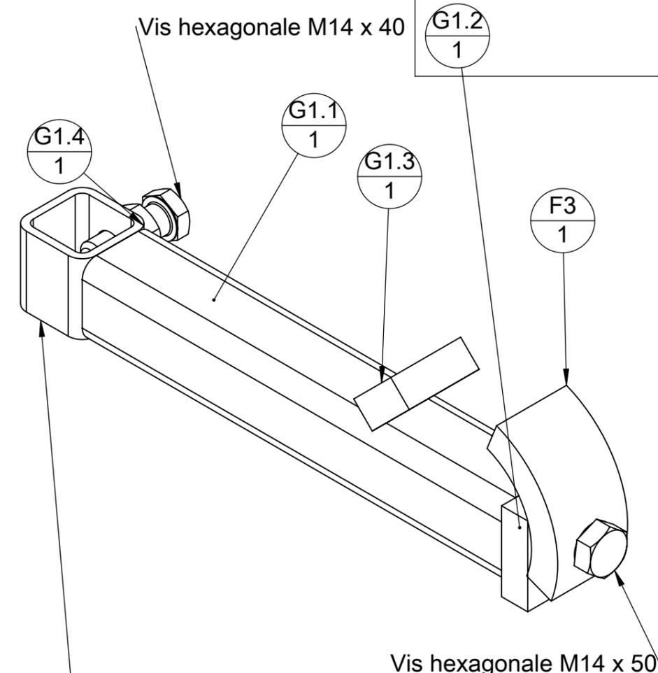
Lors de la soudure et du perçage du tube G1.4 faire attention au trait de soudure du profilé: l'orienter sur une face libre (ni trou ni cale G1.5)
