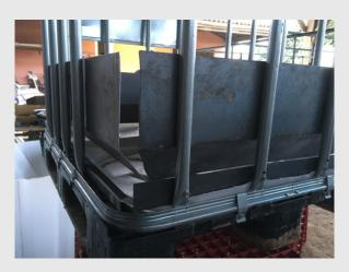
Le grain versé dans la cuve est canalisé par un « entonnoir » en tôle disposé au fond. La disposition précise de cet entonnoir permet un écoulement du grain régulier et proportionnel à la demande.
