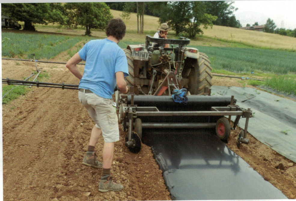
Test au champ de la version 2.0 de la dérouleuse open source par Adrien Cochet dans le cadre d'une conception d'outils participative à l'Atelier Paysan
