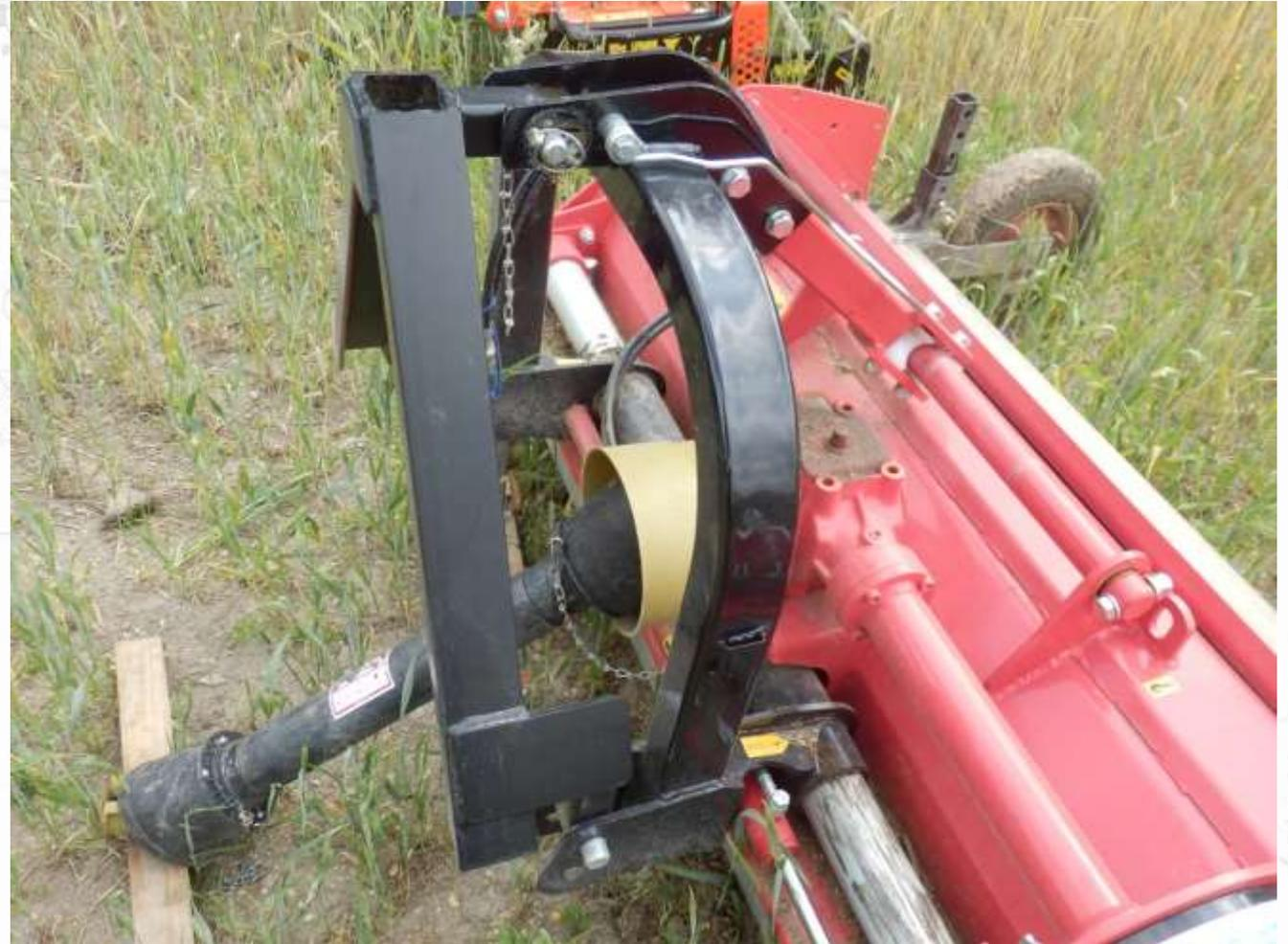
➤ Il est aussi possible de monter un système d'attelage classique sur les triangles femelles pour du matériel en commun ou en cas de revente. Dans ces exemples la bascule ne peut plus être utilisée en mode libre.
