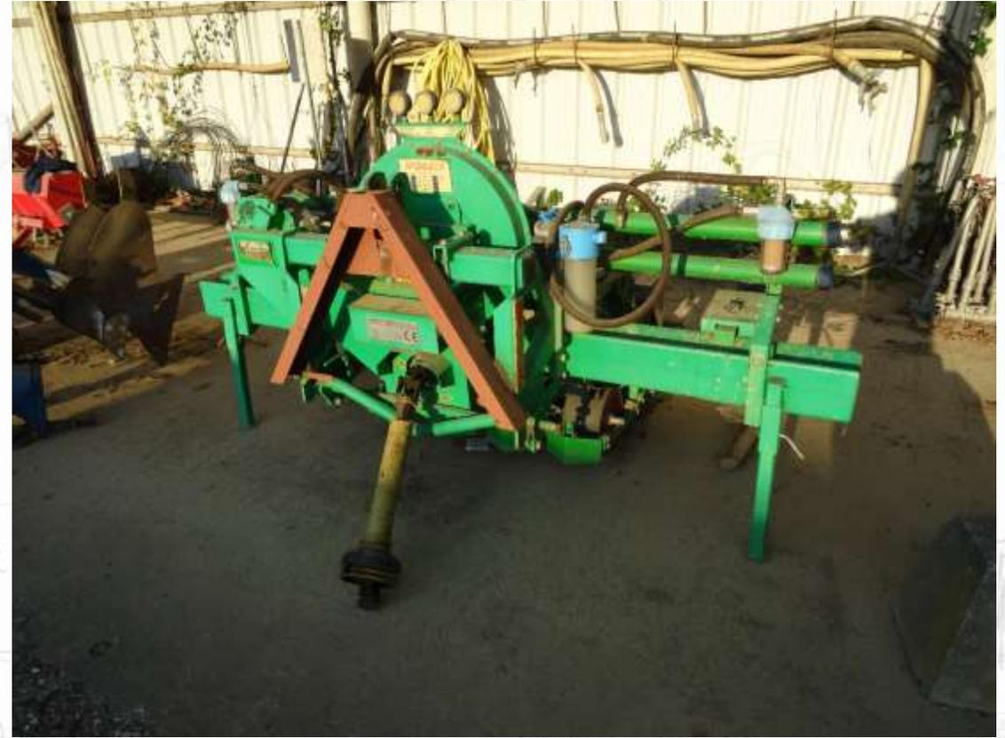
C'est un triangle mâle attelé au tracteur et un triangle femelle fixé à l'outil pour remplacer les systèmes à broches ou à barre d'attelage.
