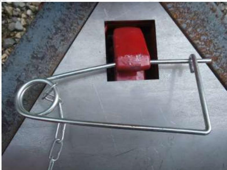
**Il est aussi possible d'auto-construire ses triangles femelles** en utilisant les plans disponibles sur le site de l'Atelier Paysan et à partir d'UPN de 80mm compatible avec le format des triangles d'attelages mâles.
