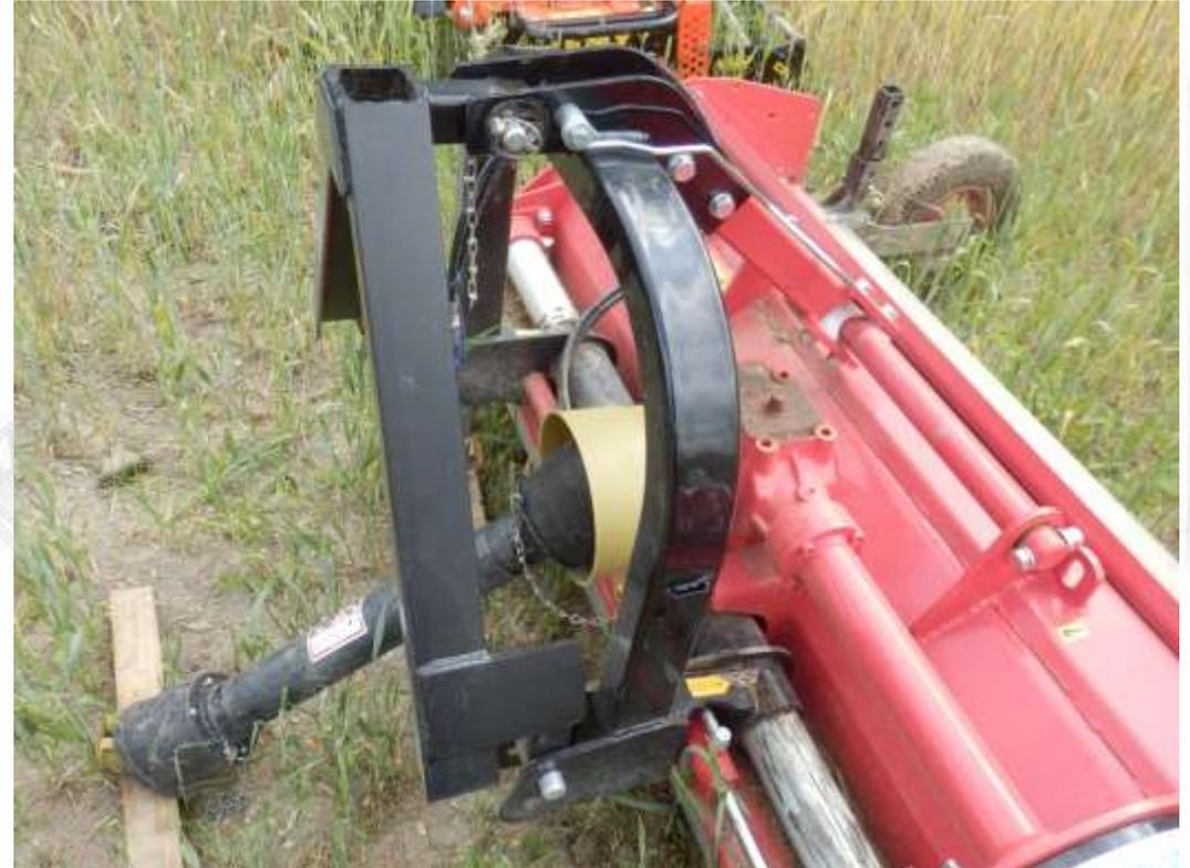
**Bien vérifier la capacité de relevage du tracteur** pour ne pas le déséquilibrer. En effet, le système triangle rajoute un peu de poids (45 kg) et aussi parfois du déport vers l'arrière si l'ancien attelage est conservé. Il est souvent souhaitable de couper celui-ci pour souder le triangle femelle au plus près de l'outil, limitant ainsi les risques de cabrage du tracteur. Dans les cas extrêmes, des masses sont bien utiles pour garder de l'adhérence sur les roues directrices.
