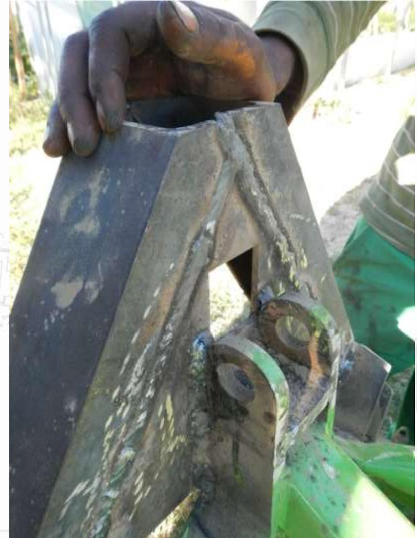
→ **C'est ici un peu le même problème que l'outil précédent,** mais en plus il n'y a pas accès au crochet pour mettre l'épingle de sécurité en cas de déplacement sur route ou en terrain accidenté
