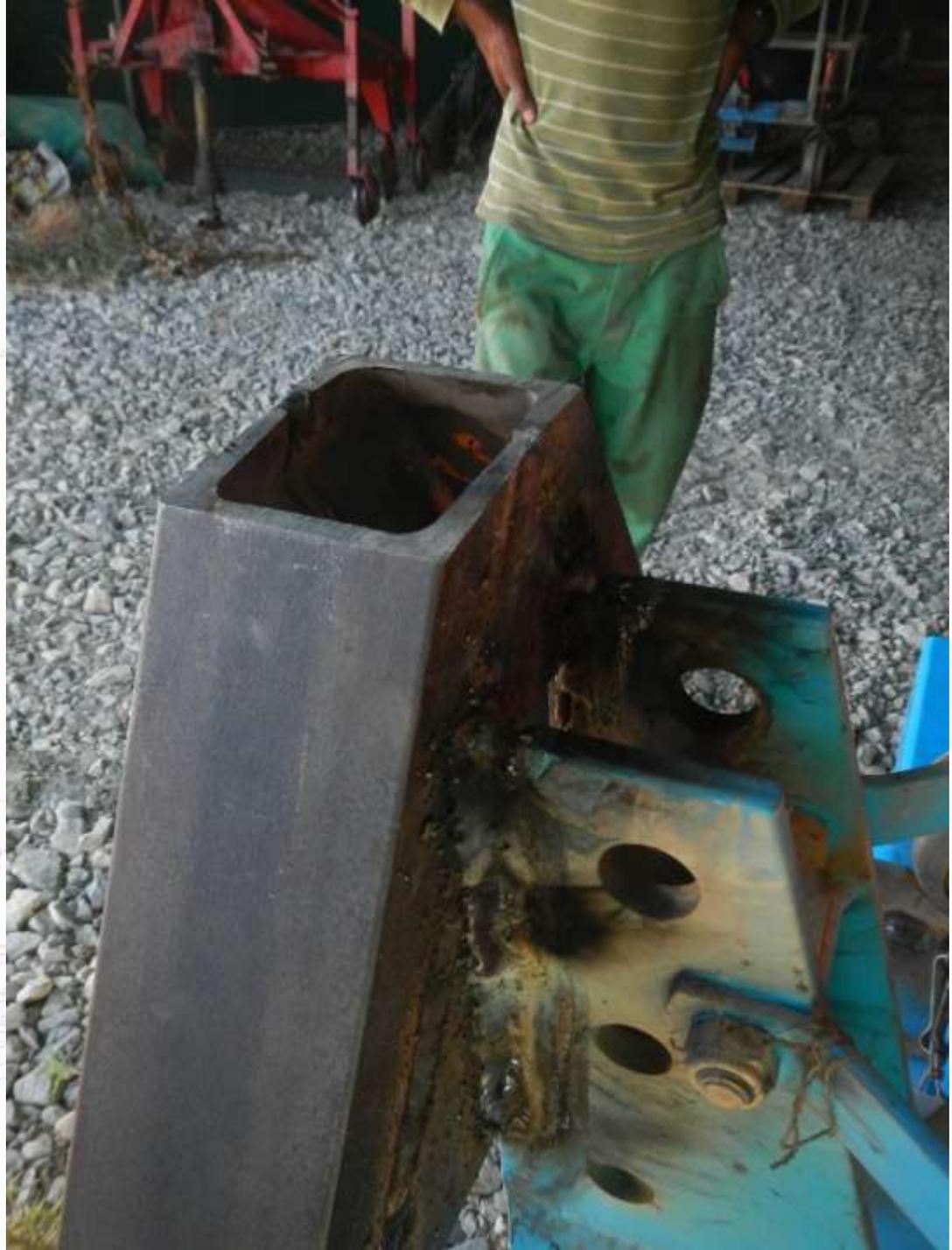
➔ Il est impératif de prendre toutes les dispositions pour réaliser des soudures fiables. L'outil doit être manipulé et orienté pour souder le plus possible à plat. Les pièces à souder doivent être nettoyées à la disqueuse pour assurer une bonne accroche de la soudure, surtout dans les angles très resserrés. Le réglage de l'intensité du poste à souder doit être bien ajusté aux conditions d'assemblages.
