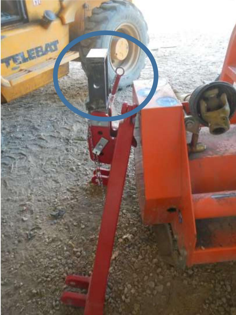
→ **La bascule** : cette pièce est installée en permanence entre le 3ème point et le triangle. Elle a un débattement de 9 cm quand elle est fixée au triangle à l'aide d'une seule broche, et elle devient fixe quand on lui ajoute une deuxième broche (photo ci-contre).
