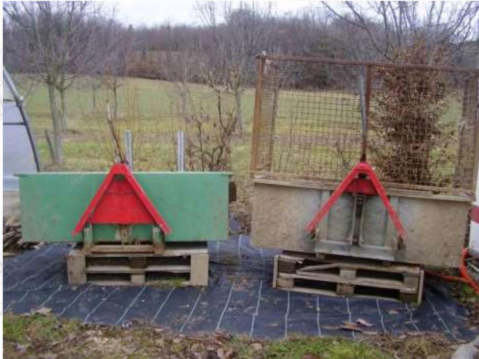
↙ **Deux bennes** avec le déclenchement au dessus des triangles en reprenant le système d'origine.
