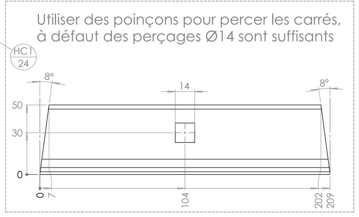
Utiliser des poinçons pour percer les carrés, à défaut des perçages Ø14 sont suffisants
