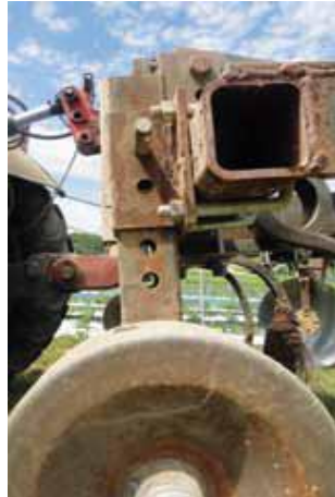
Assemblage chape de roue de jauge – bras de roue de jauge (ici sur Cultibutte)
