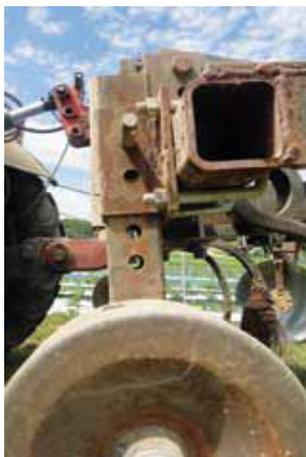
Assemblage chape de roue de jauge – bras de roue de jauge
