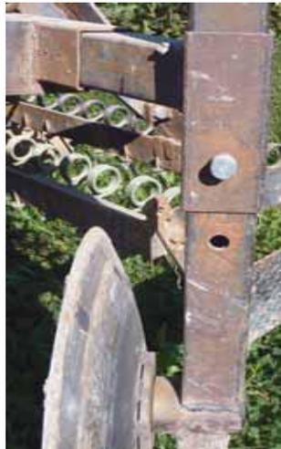
Assemblage bras de disque horizontal et vertical
