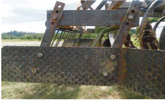
Assemblage bras de déflecteur – herse (pièces C et K)
