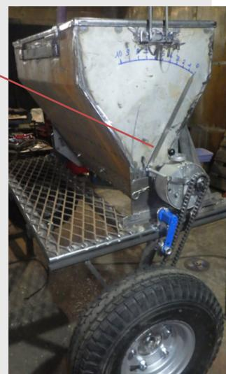
Des déflecteurs permettent de choisir la zone de dépôt de l'engrais
