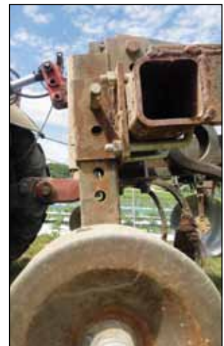
Assemblage chape de roue de jauge – bras de roue de jauge (H-L)
