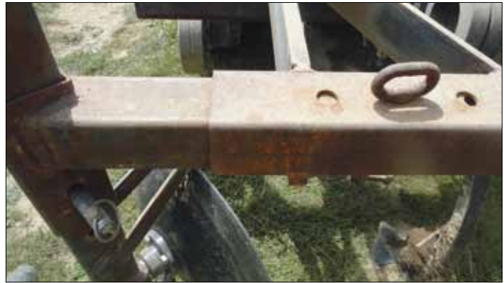
Assemblage châssis porte-disques – bras horizontal (B-E)
