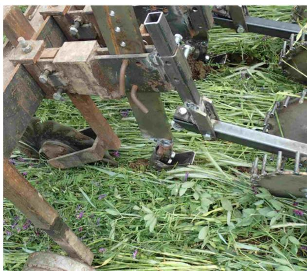
△ A l'avant de l'outil des disques coudés, réglables en hauteur, fendent la terre. Les dents également réglables se trouvent sur le même axe que les disques. Une goulotte sur les dents fait tomber les graines qui arrivent par les tubes dans le sillon (les tubes ne sont pas installés dans l'outil en photo).
