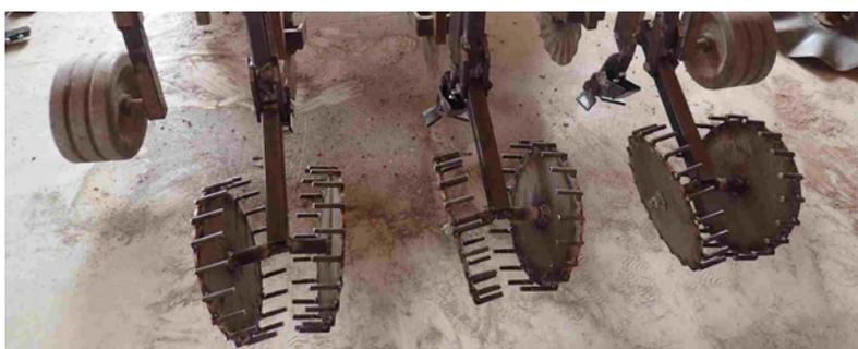
◁ Les trois roues dentées, installées à l'arrière de l'outil, appuient le sillon et le referment (Les mauvaises herbes pourraient profiter d'un sillon ouvert pour pousser). Le débattement des roues, réglable par une vis, leur permet de suivre le terrain.
