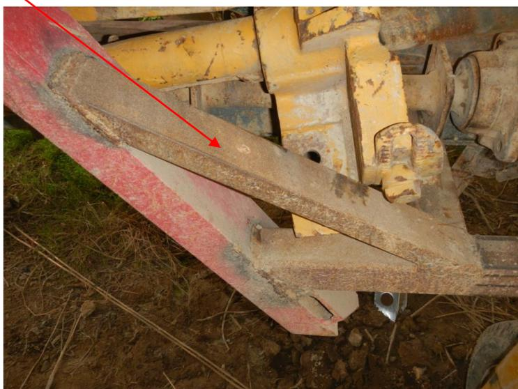
Lorsque le triangle est monté sur l'outil, il faut régler la butée du triangle femelle. Après avoir attelé et soulevé l'outil, remontez et serrez cette butée pour qu'il n'y ait plus de jeu possible entre le triangle mâle et l'outil, afin d'éviter toute secousse.
