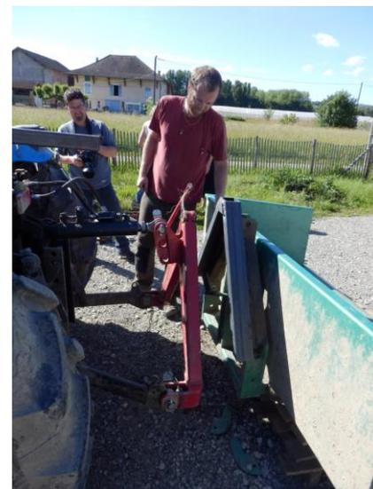
**(iii)** minimiser la distance entre l'outil et le centre de gravité du tracteur, pour ne pas augmenter le bras de levier entre les deux : privilégier, lorsque c'est possible, le remplacement des oreilles du 3 point par le triangle.
