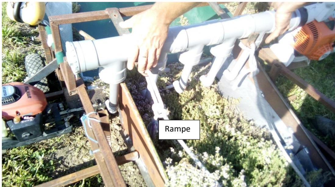
Pour le cas de la rampe on s'est rendu compte que les sorties les plus proches du souffleur ont moins de pression que celle à l'opposé. Il est envisageable pour un confort d'utilisation de passer sur un souffleur électrique, voir même de s'en passer en travaillant sur un tapis d'acheminement (tapis roulant) et améliorer la forme de l'avaloir voire l'angle de la lame de coupe.
