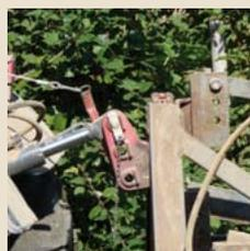
**4. Dételage :** tirer sur le levier d'ouverture avant de poser l'outil pour que le loquet libère facilement. Ensuite, il est possible de corriger la position du triangle mâle avec les réglages du troisième point pour le libérer complètement.
