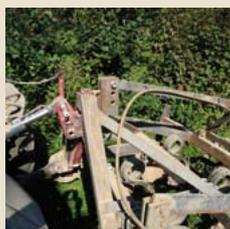
**3. Attelage :** en levant le triangle mâle, le triangle femelle se met en place et l'outil est attelé. Il est possible de vérifier visuellement depuis le tracteur si le loquet est bien enclenché en observant la position du levier d'ouverture.
