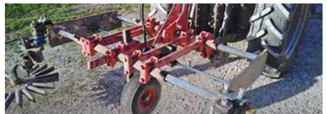
Combinaison pointes disques émotteurs sur plaque 65 x 65 + 50 x 50
