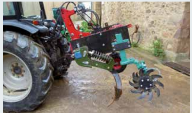
Combinaison pointes disques émotteurs sur plaque 65 x 65 + 50 x 50
