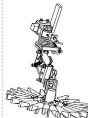
Les parallélogrammes sont compatibles avec les 2 types d'étoiles. Il est donc possible d'intervertir les étoiles pour s'adapter au mieux à vos conditions de travail.
