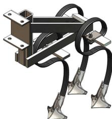
En alternative aux supports de dents sur parallélogramme, vous pouvez aussi choisir des supports 3 dents équipés de leur dents de vibroculteur courbes : avec un soc 200mm à l'avant et deux socs de 105mm sur les côtés
