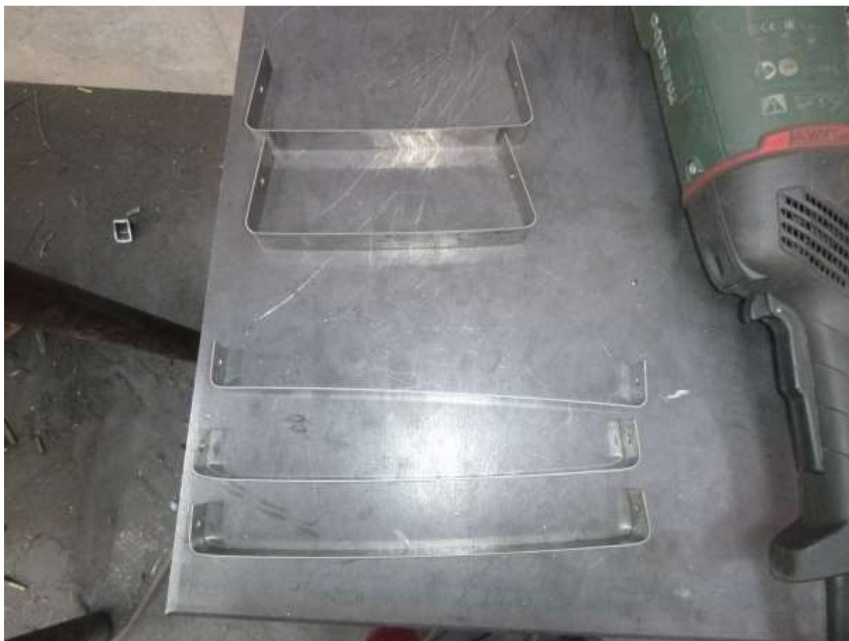
En haut : clinquant pour sarcloir oscillant / En bas : clinquant pour roue bineuse
