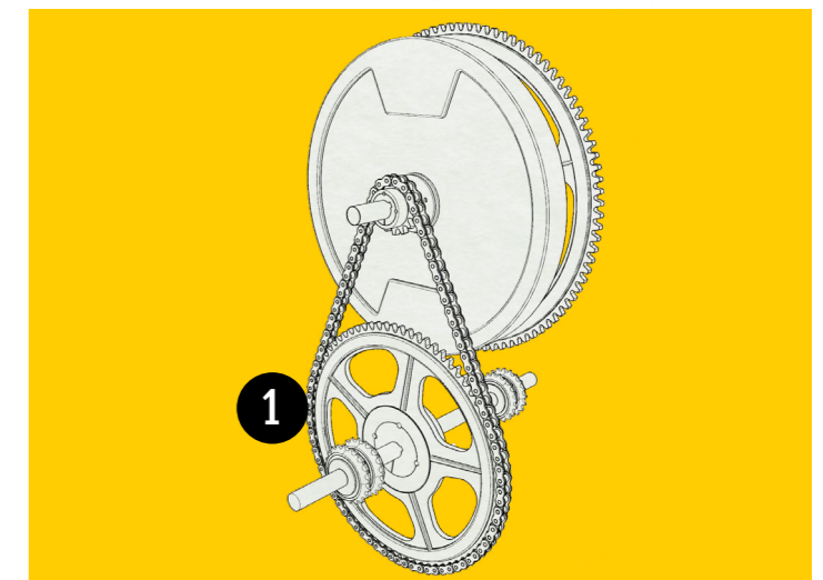
1 x 1 Chaîne 08B pas 12.7mm REF CH08B1-MT
