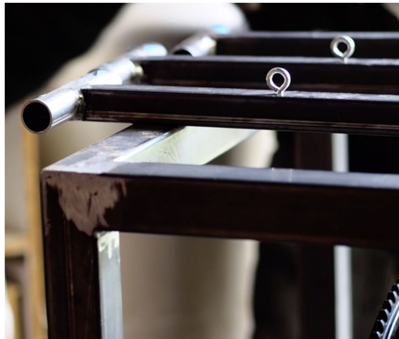
Pose des écrous à œil
