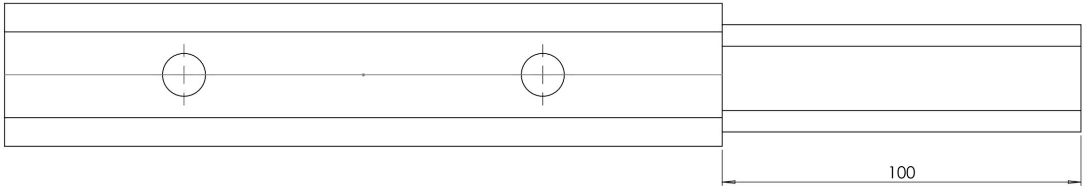
Le tube est plaqué dans le coin et les soudures bouchons se font sur une face plaquée.
