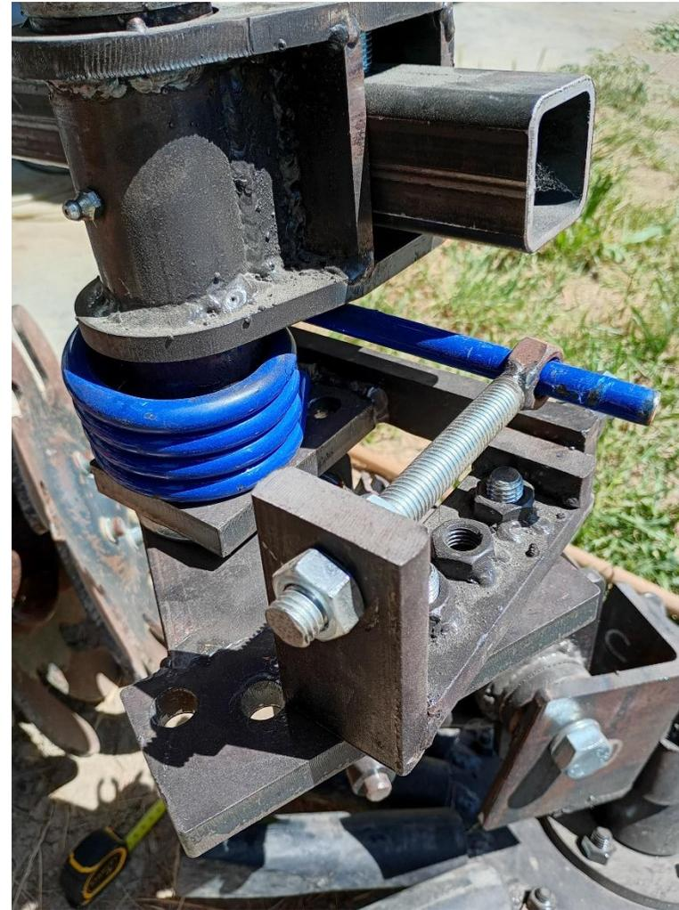
**Axe d'attache / Orientation de l'étoile** : cette différence d'orientation peut être réglée par les 3 « Réglages d'orientation de l'étoile ». Ainsi, par rapport à l'axe d'attache, l'orientation de l'étoile peut être choisie sur les 360 degrés. Par  $\frac{1}{4}$  de tour avec le réglage n°1 et plus finement sur le réglage 2 puis 3. La tension du ressort est ensuite à adapter en fonction. Voici quelques photos d'un exemple de réglage.
