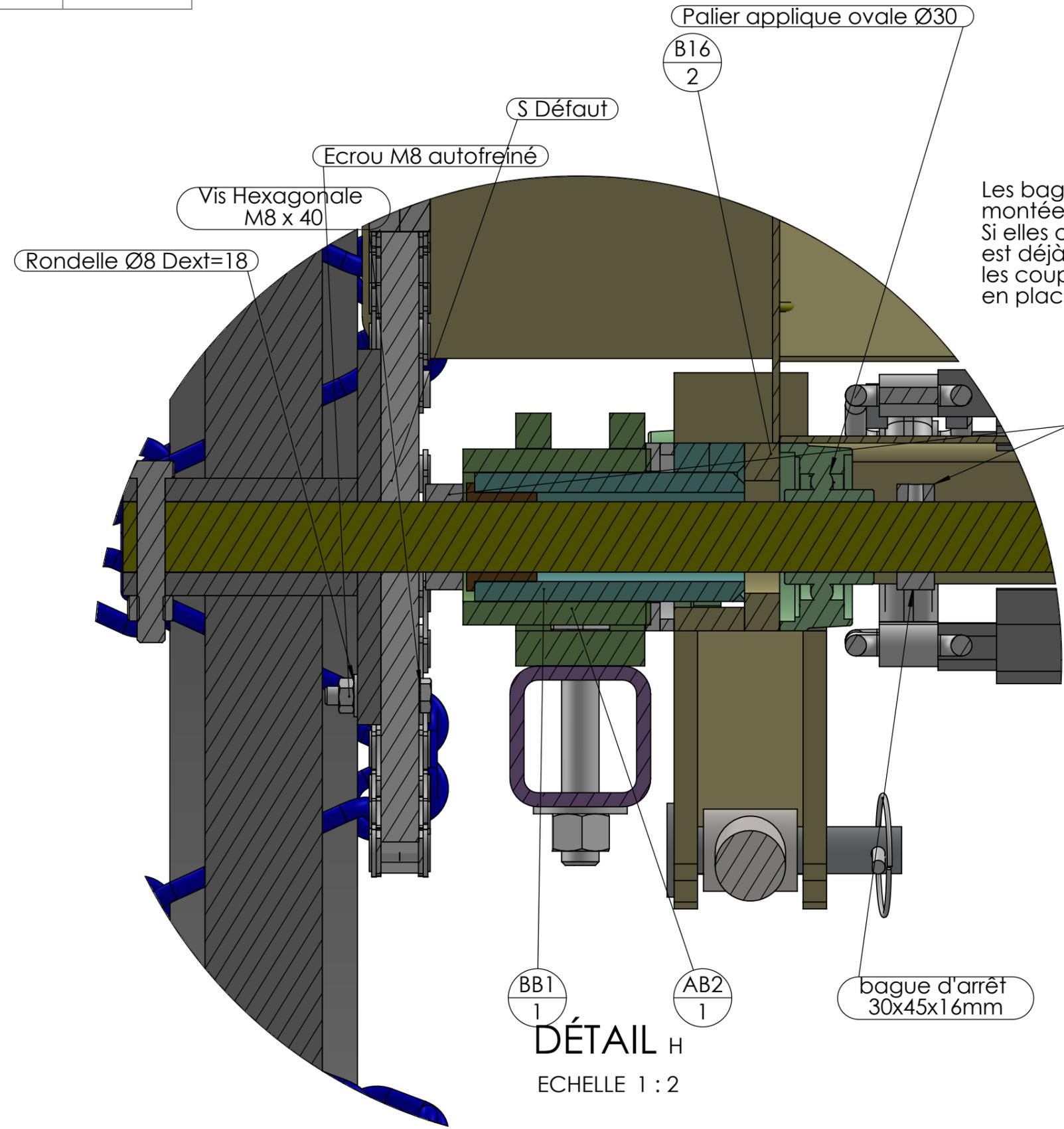
Les bagues d'arrêt doivent être montées en même temps que l'axe. Si elles ont été oubliées et que l'axe est déjà monté, il est possible de les couper en deux et de les pointer en place.
