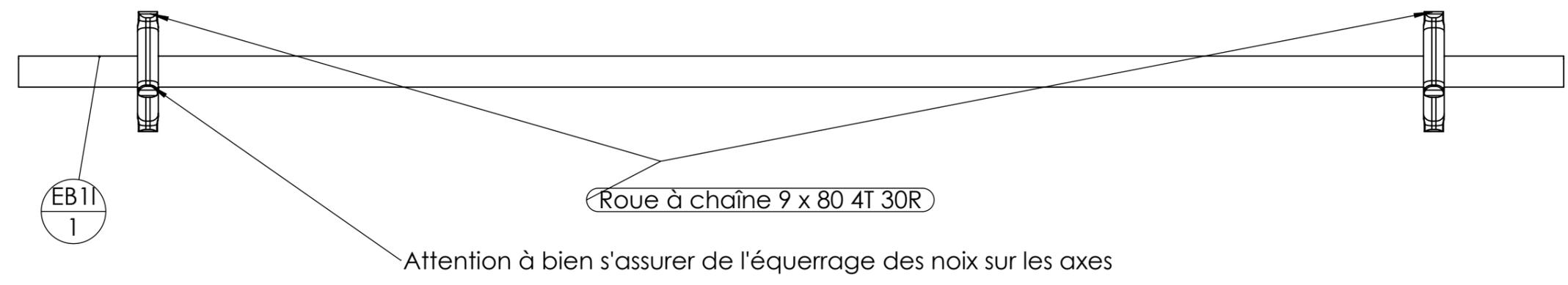
Pour bien percer l'axe, utiliser un trusquin pour marquer le milieu de l'axe sur sa longueur et son extrémité. Une fois dans l'étau, vérifier la coaxialité à l'aide d'une équerre.
