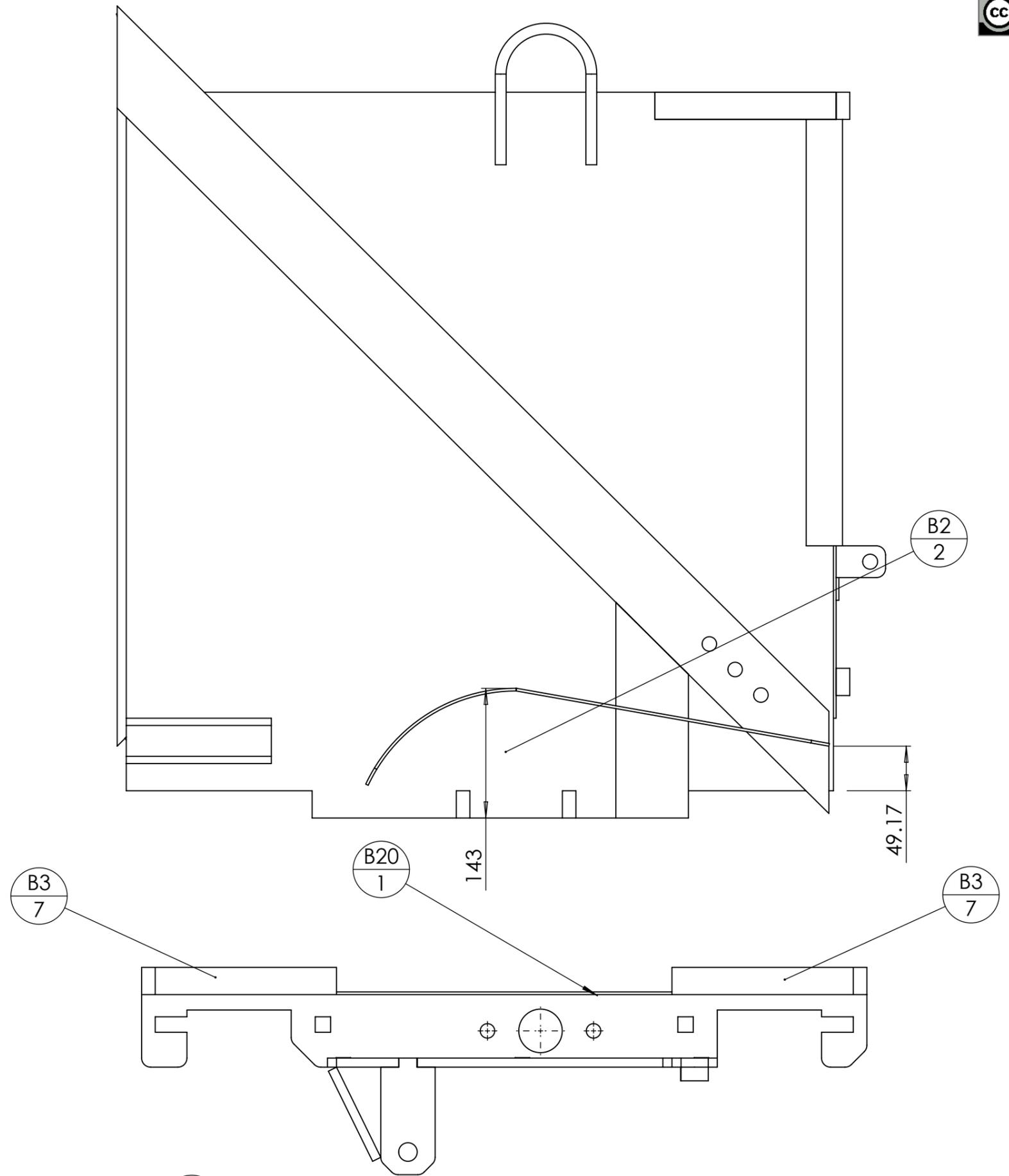
Les tôles  $\frac{B2}{2}$  viennent s'emboîter dans les pièces  $\frac{B3}{7}$ , le centrage se faisant en les positionnant à fleur.
