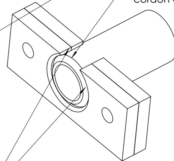
Chanfrein de la pièce tournée à placer à l'intérieur pour faciliter le cordon de soudure
