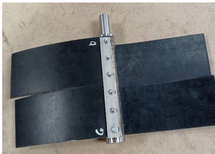
Montage de l'axe (ici avec un fer plat, remplacé par des rondelles dans la version actuelle)
