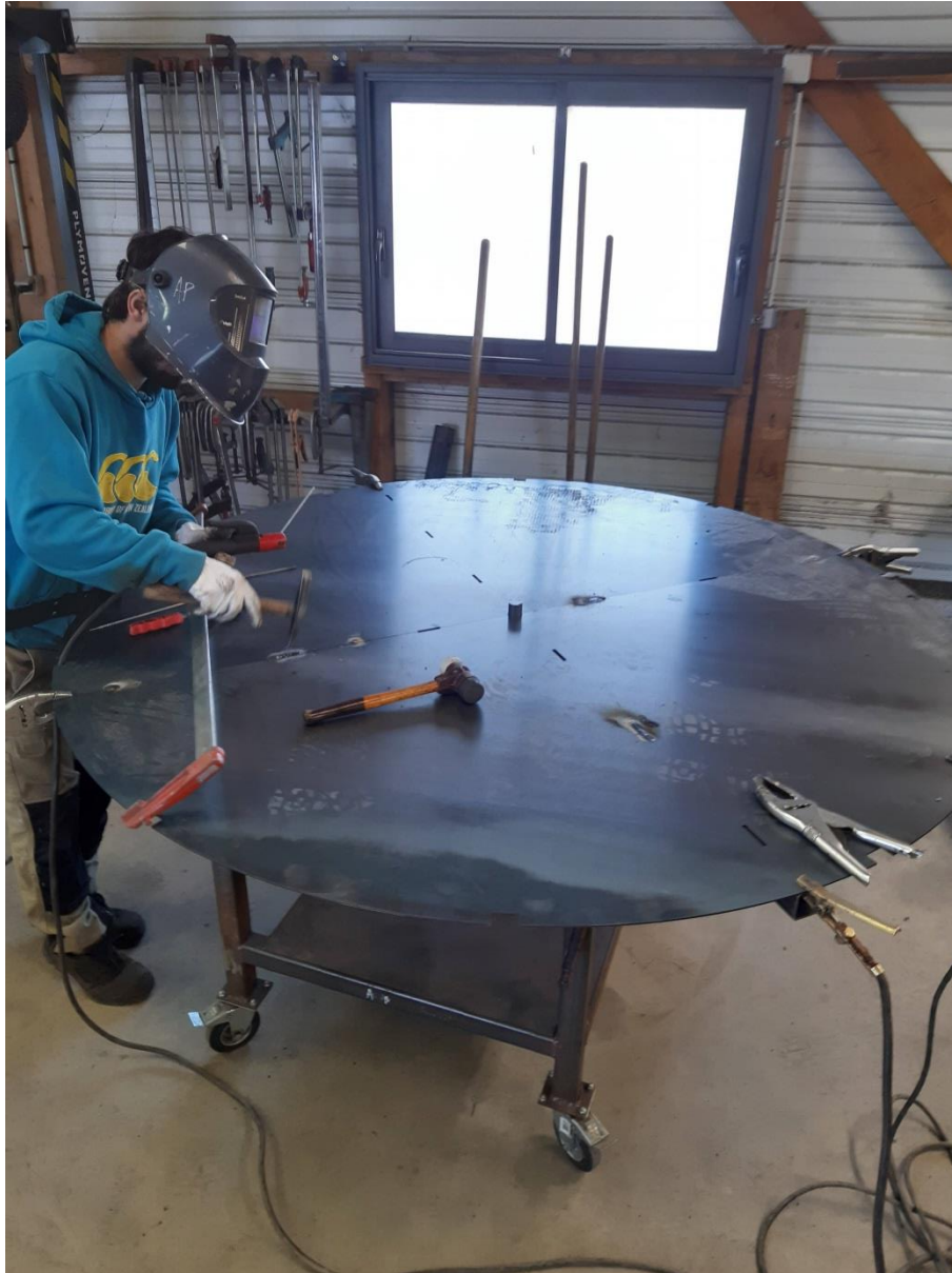
Souder les deux Fonds inférieurs A4 et A4' sur la croix.
